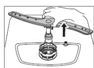
Vápník a nečistoty z vody na oplachování mohou upatit trysky a ložiska v rozprašovacím rameni. Výstupy trysk rozprašovacího ramena kontrolujte pravidelně kvůli ucpání.
