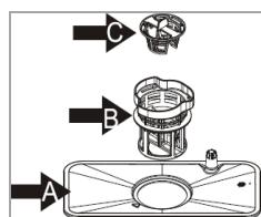
Trojdielny filtračný systém zabraňuje vniknutiu väčších kusov jedla a iných predmetov do čerpadla.
