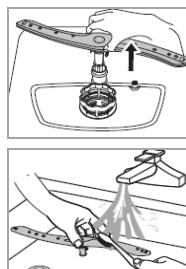
Kamień i zanieczyszczenia z wody zmywającej mogą blokować dysze i łożyska ramienia spryskivacza. Regularnie sprawdzaj dysze wylotowe ramienia spryskivacza pod względem zatorów.
