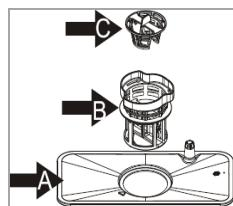
Das dreiteilige Filtersystem verhindert, dass größere Mengen an Speiseresten oder Fremdkörpern in das Spülssystem gelangen.
