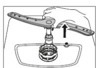
La cal y las impurezas del agua de lavado pueden obstruir boquillas y rodamientos del brazo de rociado. Compruebe con regularidad si existen obstrucciones en las boquillas de salida del brazo de rociado.
