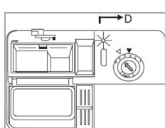
Als het glansmiddel-controlelampje op het bedieningspaneel niet brandt, kunt u de hoeveelheid resterend glansmiddel schatten met behulp van de optische niveau-indicator (D) naast het reservoir.
