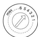
Sejměte víko dávkovače prostředku na oplachování a ovladač nastavte na požadovanou úroveň. Tovární nastavení je „4“.
