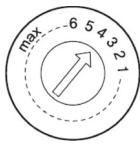
Nehmen Sie den Deckel des Klar-spülmittelbehälters ab und drehen Sie den Wahlschalter in die gewünschte Stellung. Die Werkseinstellung ist "4".
