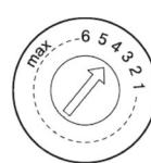
Haal het deksel van het glansmiddel-reservoir af en draai de knop naar het gewenste niveau. De fabrieksinstelling is "4".
