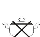
Töpfe mit rundem Boden. Durchmesser am Boden kleiner als 12 cm ist.
