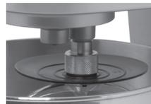
l'arbre d'entraînement. Tournez le mandrin à desserrage rapide dans le sens des aiguilles d'une montre jusqu'au filetage de l'outil.
