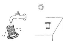
Nach jedem dritten Entleeren oder bei stärkeren Verschmutzungen reinigen Sie den Filter, indem Sie fließendes Wasser entgegen der Blasrichtung durch das Filtervlies laufen lassen.
