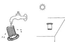
À chaque troisième vidange ou en cas de saillances importantes, nettoyez le filtre en faisant couler de l'eau à travers le tissé du filtre dans le sens contraire du flux d'air. Ne le remettez en place qu'une fois le filtre entièrement séché!
